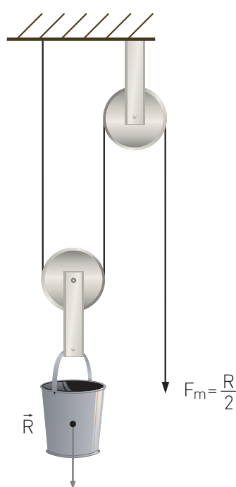
↑ Combinación de polea fija y polea móvil.
